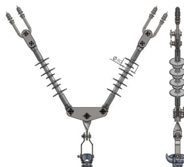
ES-LSV 35-120 Lanț dublu de susținere în V, cu clema CLAMS 35-120
