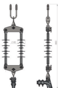
ES-LDI 35-50 FL ES-LDI 50-95 FL Lanț dublu de întindere faza laterală cu clema CLAMI 35-50 sau CLAMI 50-95
